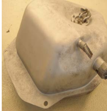
Manche Teile waren nur noch durch Sandstrahlen zu retten und erhielten mehrere Schutzanstriche.
