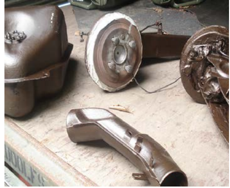
Manche Teile waren nur noch durch Sandstrahlen zu retten und erhielten mehrere Schutzanstriche.
