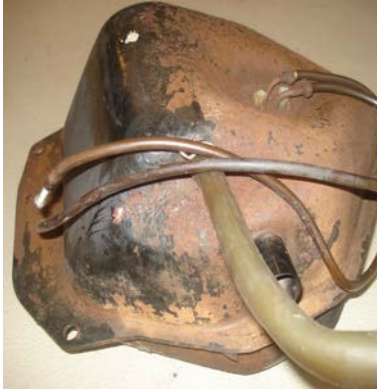
Manche Teile waren nur noch durch Sandstrahlen zu retten und erhielten mehrere Schutzanstriche.
