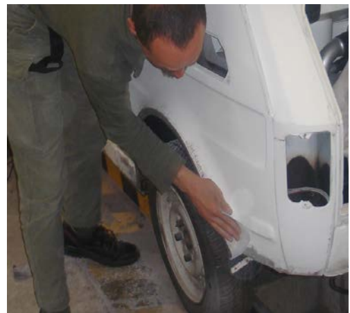
Manche Teile waren nur noch durch Sandstrahlen zu retten und erhielten mehrere Schutzanstriche.
